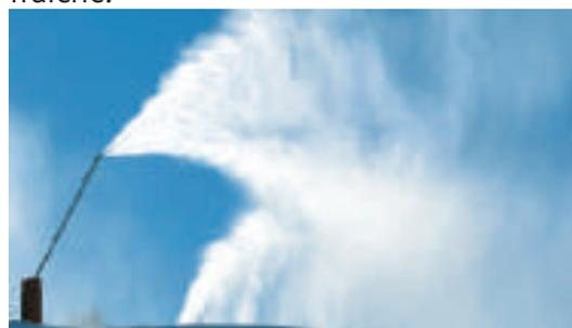
Le principe de production de la neige de culture consiste à pulvériser de l'eau sous forme d'un brouillard dans une atmosphère à basse température pour que les gouttelettes d'eau congèlent avant d'atteindre le sol.
